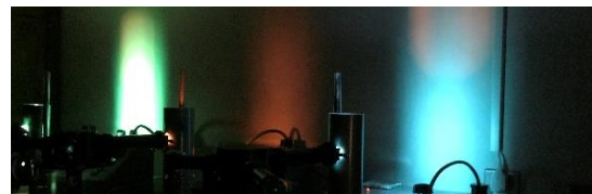
図2. 「輝線スペクトル」観察実験装置（暗室） 左からHg, Na, Cdの順
